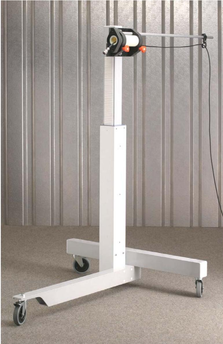
Höhenverstellbares Säulenstativ aus weitestgehend dielektrischen Materialien zur Aufnahme von Antennen und Meßsonden.
